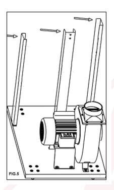
THE COLLECTOR SUPPORT CAN BE MOUNTED TO THE BASE PLATE AS SHOWN FIG.5.
