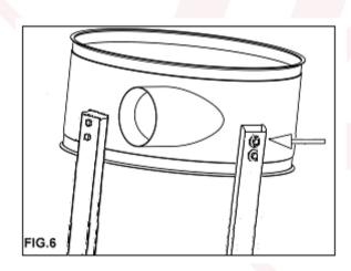
NOW ATTACH THE COLLECTOR TO THE THREE COLLECTOR SUPPORTS MAKING SURE THE SIDE HOLE IN FACING THE COLLECTOR BODY AS SHOWN IN FIG.6.
