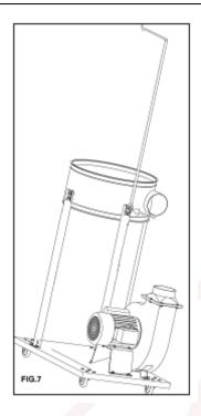
AT THIS TIME THE UPPER BAG SUPPORT BE INSTALLED ONTO THE COLLECTOR SUPPORT AS SHOWN IN FIG.7.
