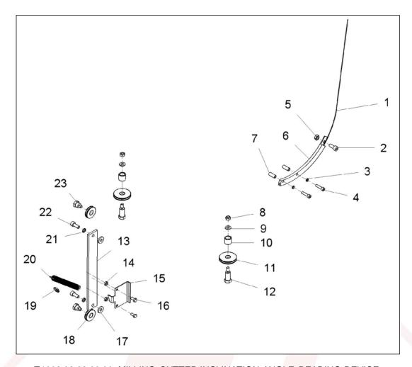
T1002.02.08.00.00. MILLING CUTTER INCLINATION ANGLE READING DEVICE
