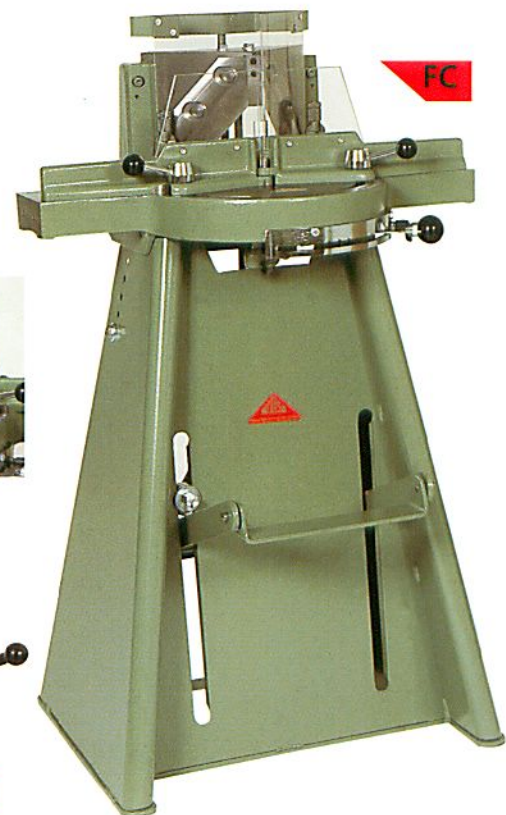
MORSØ-FC mit Nackenmessern zum Sprossenstanzen
