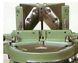
MORSØ-FC mit Nackenmessern zum Sprossenstanzen
