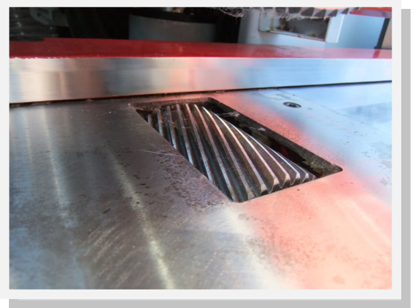
Motorisch angetriebene Gleitwalzen im Tisch für gleichmäßigen Materialtransport
