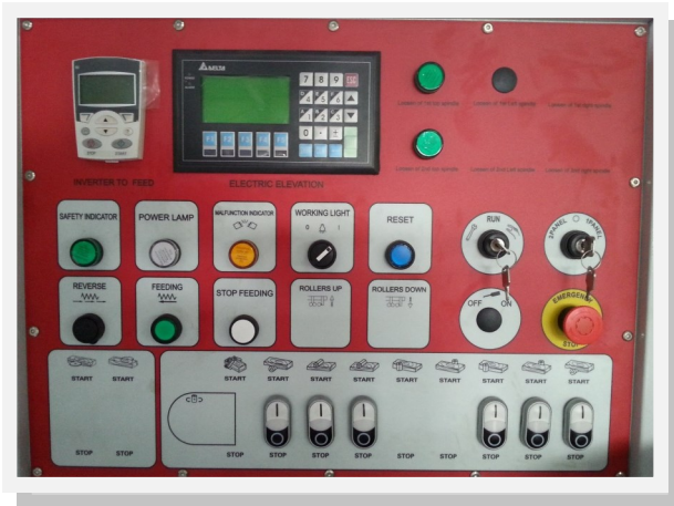
Übersichtliches Bedienpaneel mit DELTA PLC Steuerung für elektrische Verstellung der oberen Spindel und Vorschub
