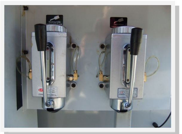
Schmier- und Gleitmittelpumpe
